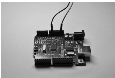
Рис. 1. Плата Arduino Uno (составлено автором)
