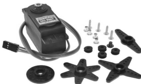
Рис. 4. Сервопривод (составлено автором)
